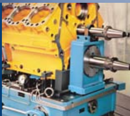
Vorrichtung für Dieselmotor Fixture for a diesel engine bloc Dispositif pour un bloc-moteur Diesel
