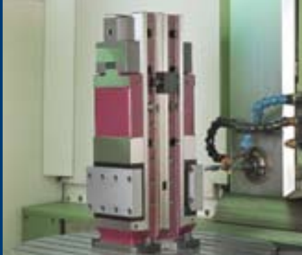
System stirnseitig auf Rundtisch gespannt System-set-up at the gable-end on the round-table Construction du système sur la frontispice et sur la table rounde
