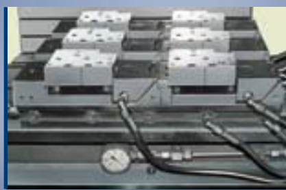
Verzahnte Spannleiste zum Mehrfachspannen Toothed Rail for Multiple Clamping Rail avec profile de dent pour Serrage Multiple
