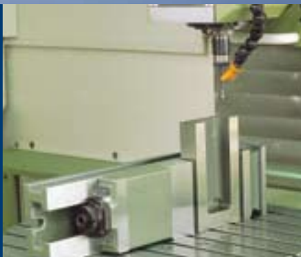
Lange Werkstücke werden 2-seitig gespannt und besser geführt Long pieces gets a better positioning and are clamped on two surfaces Mieux guidage et 2-surfaces-serrage chez les pieces longues
